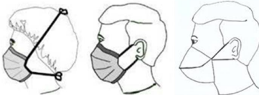
Positionnement du masque et du jeu de brides selon les modèles
